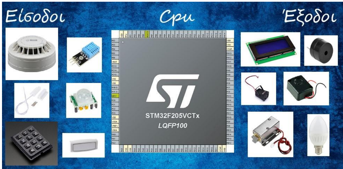
Σχήμα 3.1: Συνδεσμολογία περιφερειακών μονάδων στον επεξεργαστή
