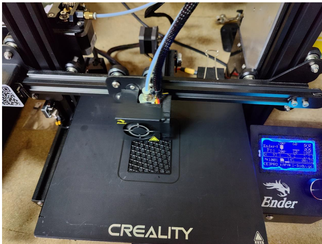
Εικόνα 3.13: Διαδικασία 3D εκτύπωσης πλαισίου συσκευής μέτρησης και εκπομπής δεδομένων
