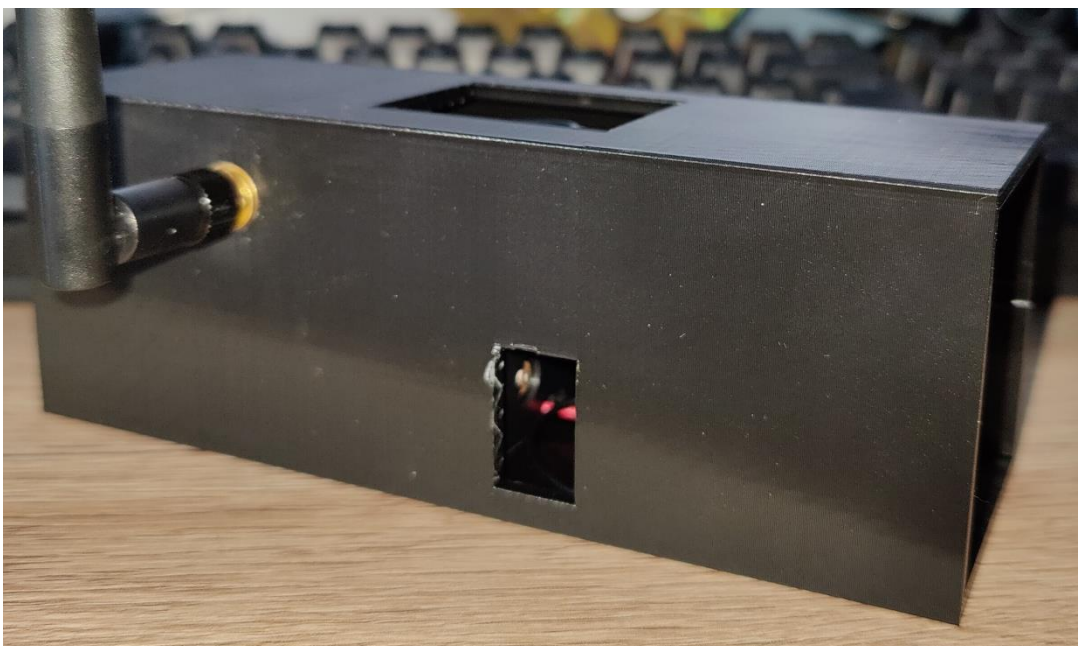
Εικόνα 3.22: Τελικό αποτέλεσμα 3D εκτύπωσης φορητής συσκευής λήψης και καταχώρησης δεδομένων
