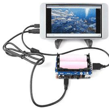
Εικόνα 2.10 Τροφοδότηση Συσκευών με το Waveshare UPS HAT
