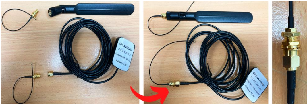
Εικόνα 2.26 Σύνδεση κεραιών με καλώδια
