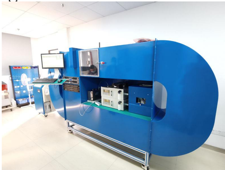
Σχήμα 4.12 Ο θάλαμος για την διακρίβωση των ανιχνευτών καπνού
