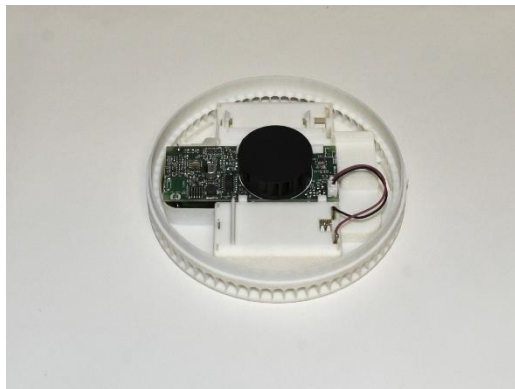
Σχήμα 3.10 Φωτογραφική απεικόνιση του εσωτερικού του ανιχνευτή καπνού
