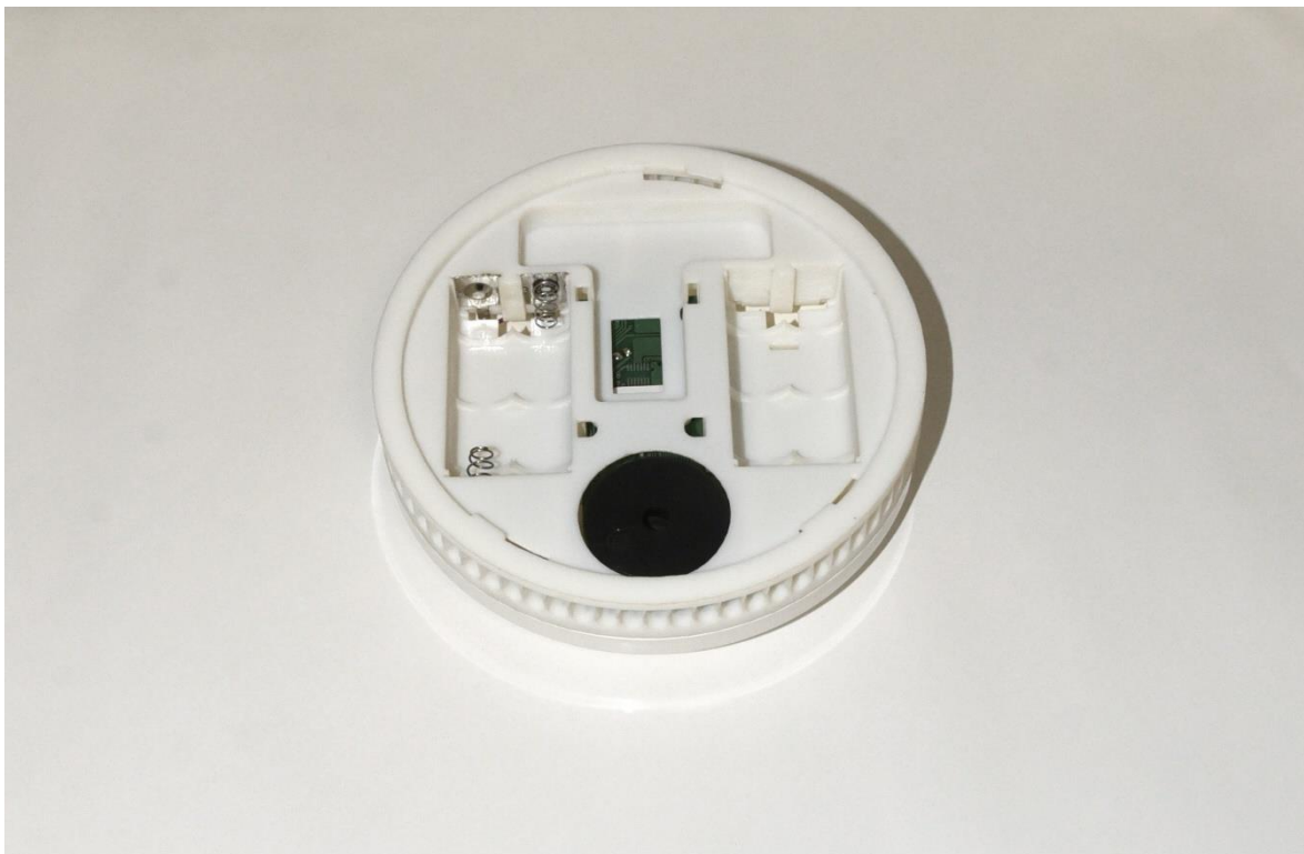
Σχήμα 6.9 Ρεαλιστική απεικόνιση της βάσης του ανιχνευτή καπνού έπειτα από την δεύτερη προσπάθεια εκτόπωσης
