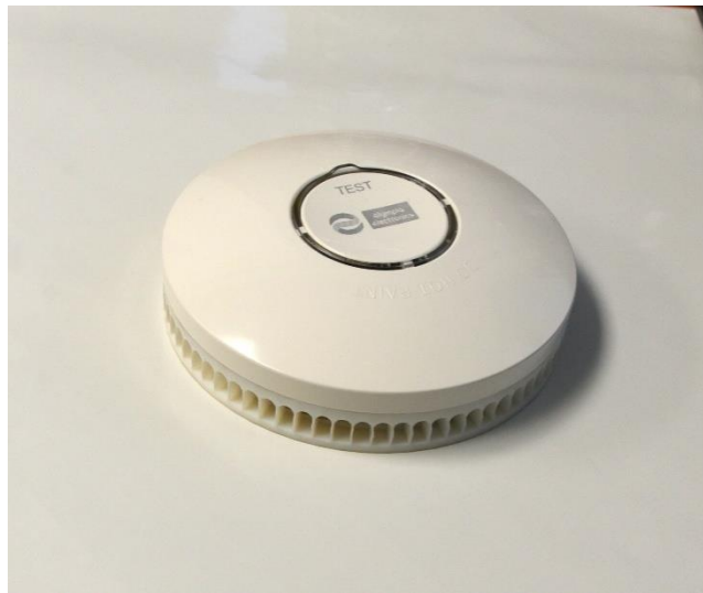
Σχήμα 3.11 Φωτογραφική απεικόνιση του βελτιστοποιημένου ανιχνευτή καπνού
