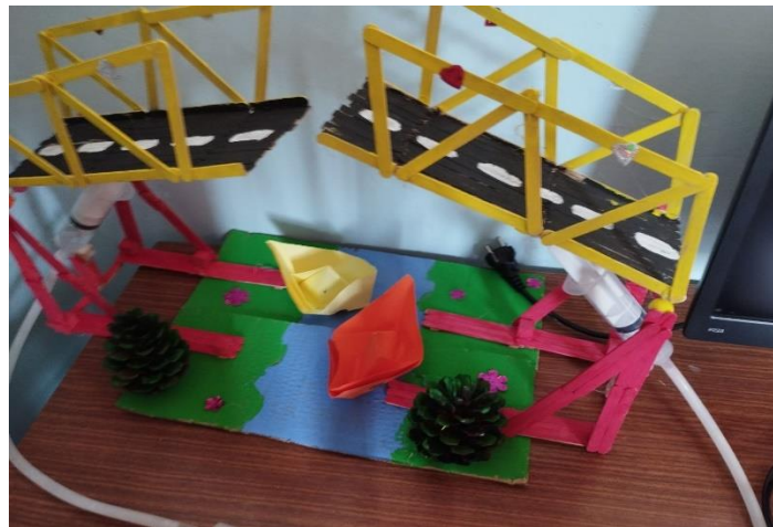
Εικόνα 2. 9 Η υδραυλική γέφυρα σε φάση ανύψωσης
