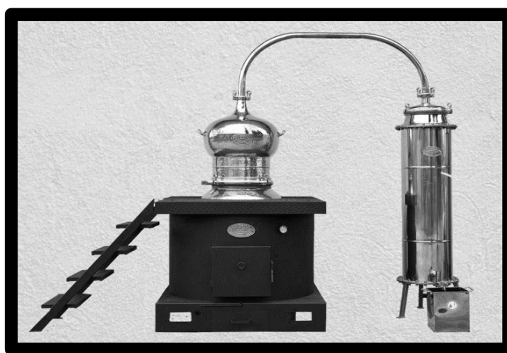
Εικόνα 3.2 Παραδοσιακή αποστακτική συσκευή ( www.elexalko.gr )
