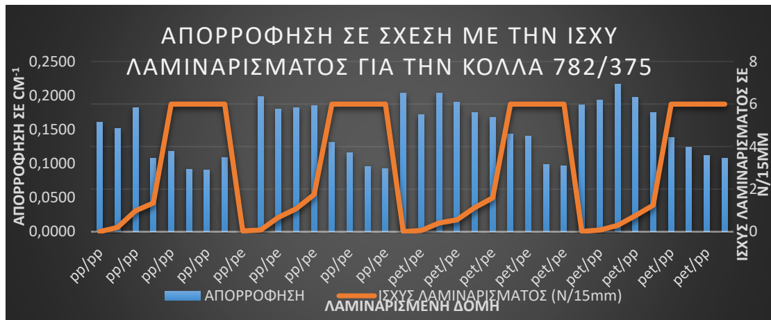
Σχήμα 42: Γραφική απεικόνιση της απορρόφησης σε σχέση με την ισχύ λαμιναρίσματος για τις δομές PP/PP, PET/PP, PET/PE και PP/PE που παραχθήκαν με την κόλλα 782/375.
