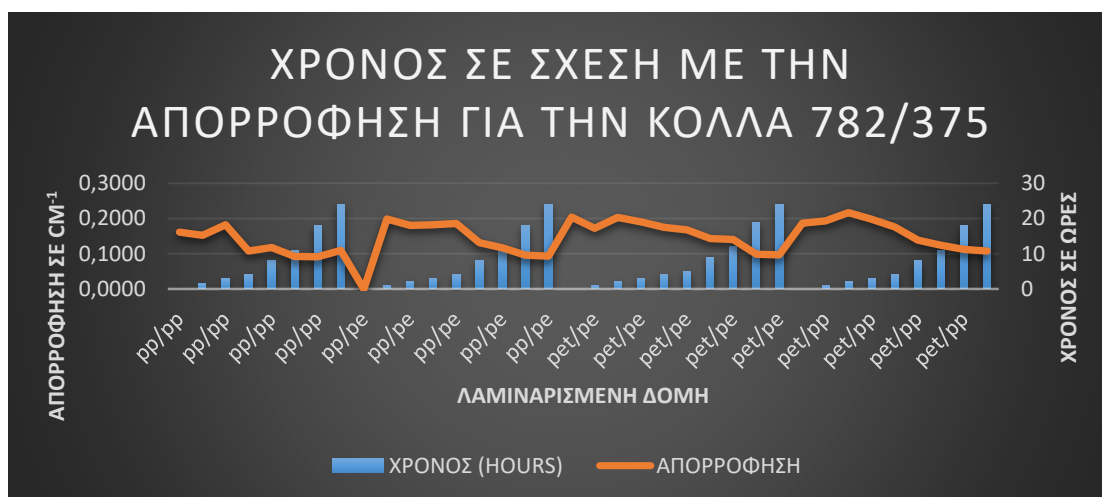
Σχήμα 41: Γραφική απεικόνιση του χρόνου σε σχέση με την απορρόφηση για τις δομές PP/PP, PP/PE, PET/PE και PET/PP και που παράχθηκαν με την κόλλα 782/375.
