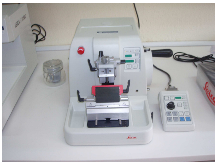
Εικόνα 13. Μικροτόμος. Κοπή τομών πάχους 5 \mu\text{m} .
