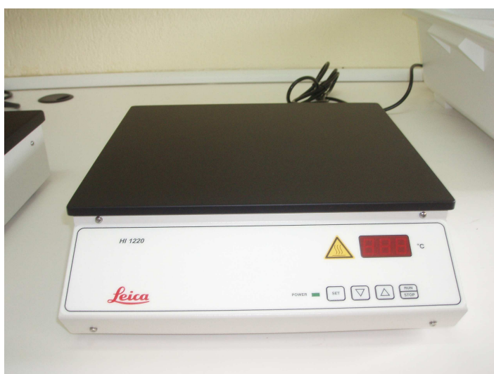
Εικόνα 15. Θερμαινόμενη τράπεζα για στένωμα τομών (Leica HI 1220)
