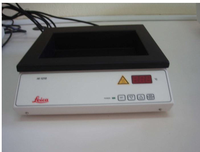
Εικόνα 14. Υδατόλουτρο για άπλωμα τομών 45 ^{\circ}\text{C} . (Leica NI 1210)
