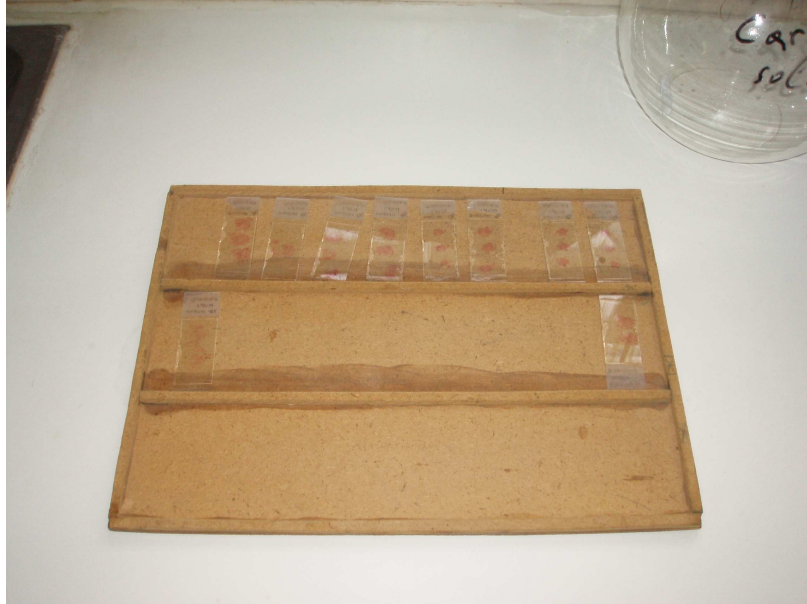
Εικόνα 17. Τελικό στάδιο παρασκευής όπου οι αντικειμενοφόροι πλάκες έχουν επικολληθεί και είναι έτοιμες για παρατήρηση στο μικροσκόπιο.
