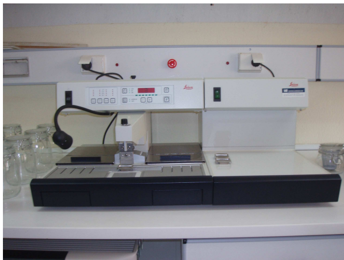
Εικόνα 12. Από αριστερά προς τα δεξιά βλέπουμε το θάλαμο θέρμανσης των λεκανιδίων σκλήνωσης, τη θερμαινόμενη επιφάνεια χειρισμών σκλήνωσης και την ψυχόμενη πλάκα όπου παραμένει το λεκανίδιο σκλήνωσης μέχρι να κρυώσει (Leica).
