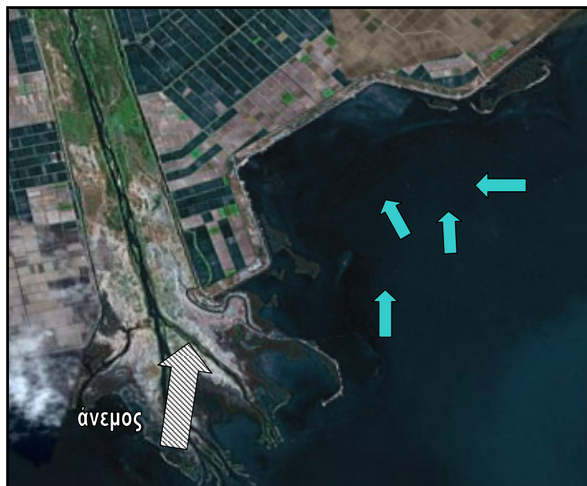
Εικόνα 34. Μοντέλο κυκλοφορίας με νότιο-νοτιοδυτικό άνεμο (από επεξεργασία των μετρήσεων πεδίου). Τα γαλάζια βελάκια συμβολίζουν το θαλάσσιο ρεύμα ενώ το άσπρο διαγραμμισμένο βέλος συμβολίζει τον άνεμο (φωτογραφία : Google earth)
