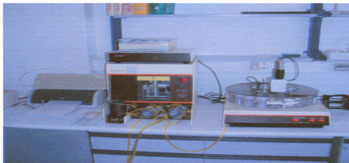
Εικόνα 22. Ο περιστρεφόμενος δίσκος του SEDIGRAPH
