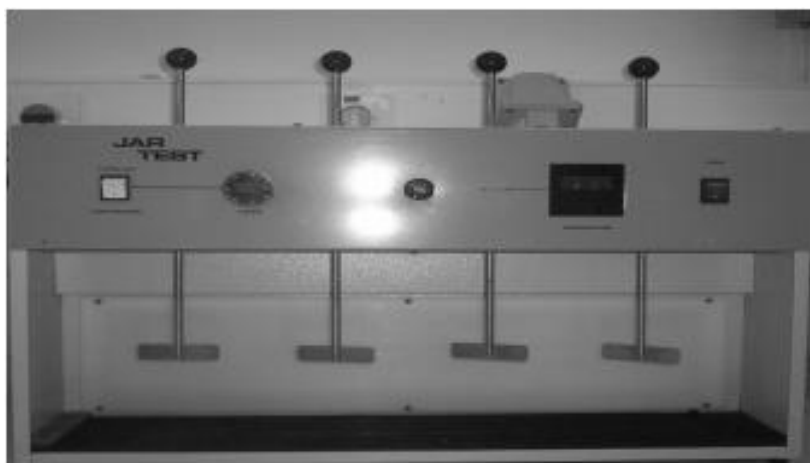
Εικόνα 9.1. Συσκευή δοκιμών κροκιδώσης (από Πεταλά, 2006).
