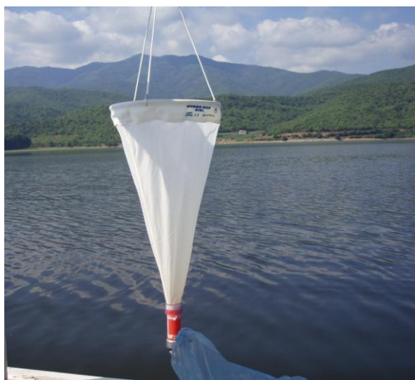
Εικόνα 2. Δίχτυ για τη συλλογή φυτοπλαγκτού (διαμέτρου 20 \mu\text{m} ) που χρησιμοποιήθηκε κατά τη διάρκεια της παρούσας έρευνας (Φώτο: Γ. Σκιαδάς).
