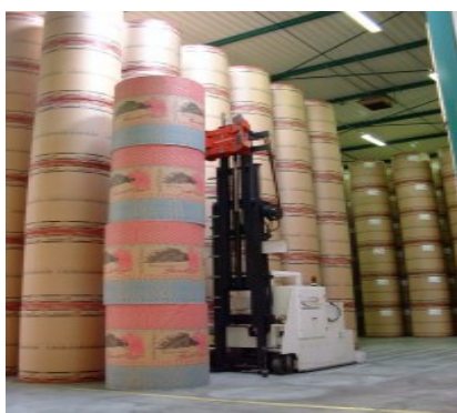
Φωτογραφία 9: Στοίβαξη στο πάτωμα
