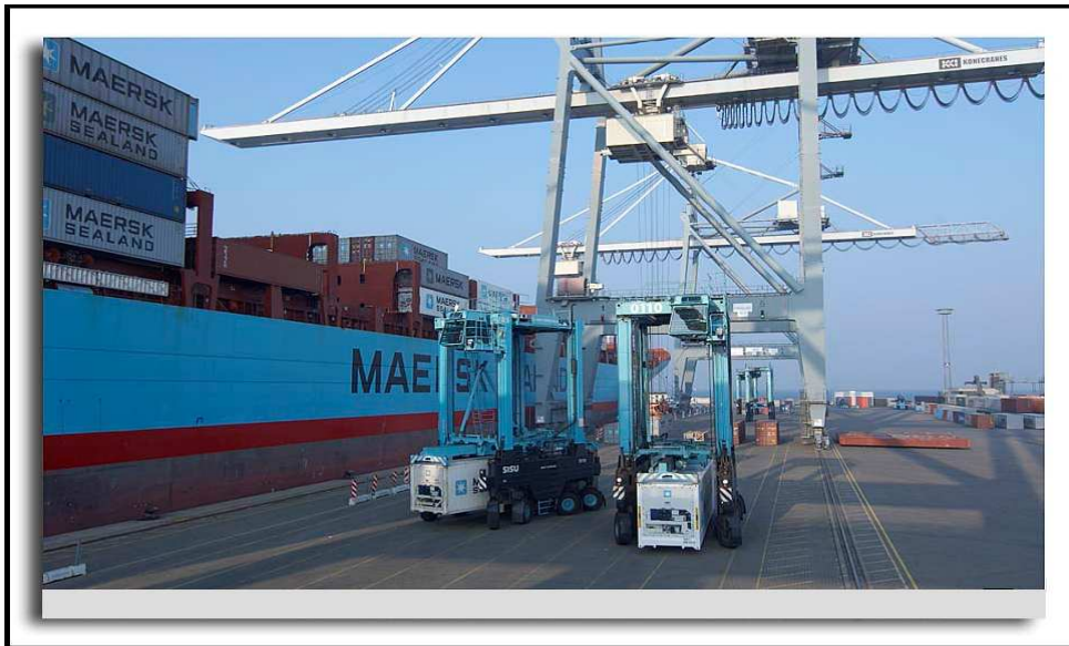
Εικόνα 1.5: Μηχανήματα straddle carriers φόρτο-εκφόρτωσης εμπορευματοκιβωτίων.
