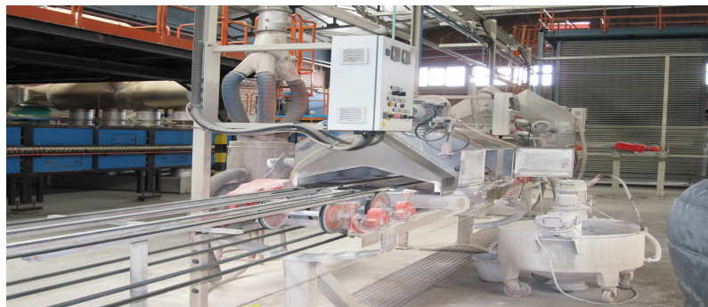
Εικόνα 4: Ξηραντήριο Κεραμικών πλακιδίων.
