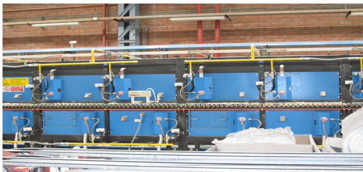
Εικόνα 2: Φούρνος Έψησης Κεραμικών πλακιδίων.
