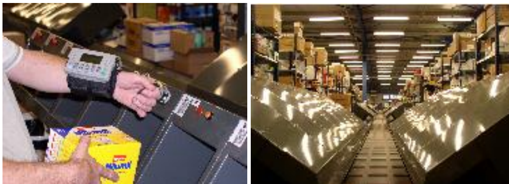
Εικόνα 18: Το πόστο των υποσταθμών - Τα scanner και η ταινία μεταφοράς (www.pharmanet.gr)
