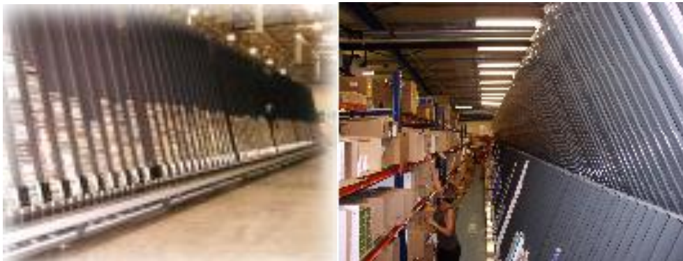
Εικόνα 20: Τα κανάλια εφοδιασμού του ρομποτικού συστήματος ( www.pharmanet.gr )
