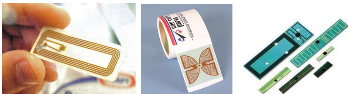
Εικόνα 7. Είδη ετικετών RFID.(13)
