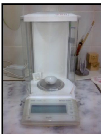
Φωτογραφία 5.2.16.8 : Συσκευή ζυγού ακριβείας 5 δεκαδικών ψηφίων. Χρησιμοποιείται στην αίθουσα εργαστηρίου Ποιοτικού Ελέγχου Ανάλυσης Νερού (πάνω στην συσκευή ζυγού είναι τοποθετημένο το ειδικό δοχείο στο οποίο τοποθετείται το δείγμα για τις μετρήσεις).
