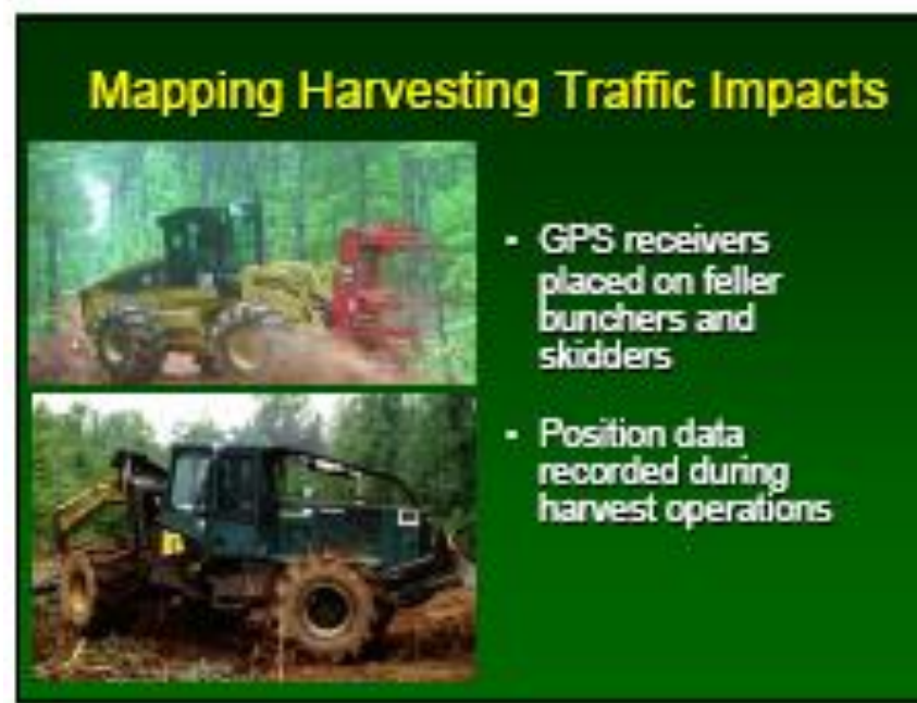
Εικόνα 11: Μηχανοκίνητα μέσα δασοκομίας ακρίβειας, εξοπλισμένα με πληροφοριακά συστήματα
