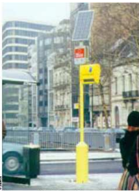
Μέσω της φωτοβολταϊκής τεχνολογίας παρέχεται ηλεκτρική ενέργεια σε αυτόνομες διατάξεις όπως μετεωρολογικούς σταθμούς, παρκόμετρα, τηλέφωνα έκτακτης ανάγκης και, στη συγκεκριμένη περίπτωση, σε έναν πίνακα πληροφοριών σε στάση λεωφορείων.
