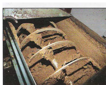
Μάλαξη της ελαιοζύμης με ειδικούς μαλακτήρες σε σύγχρονο φυγοκεντρικό ελαιοτριβείο.
