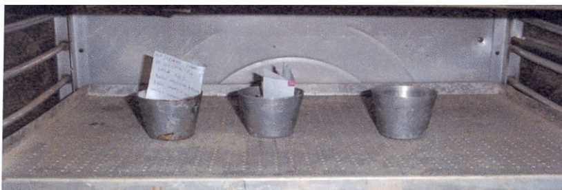
Εικόνα 1.5: Δοκίμια προς ξήρανση στο φούρνο
