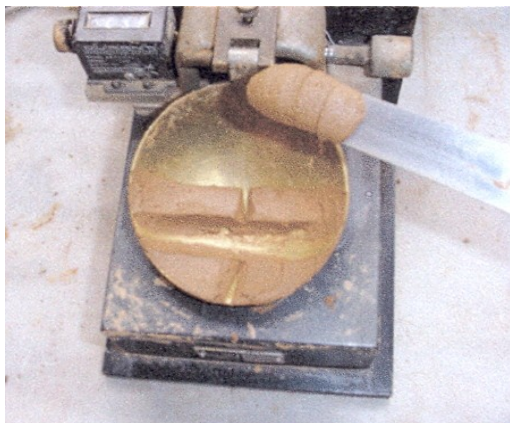
Εικόνα 8.10: Λήψη δείγματος για προσδιορισμό της φυσικής υγρασίας
