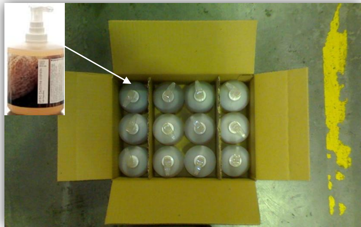
Εικόνα 3.2.1.2.γ. Εφαρμογή κιβωτοποίησης χαρτοκιβώτιο που θα καλύπτει την ανάγκη και των δύο, χωρίς όμως να υπάρχει όφελος σε σχέση με τις παλετοθέσεις και στα δύο.
