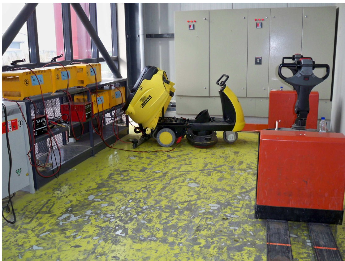
Εικόνα 17: Μηχάνημα απολύμανση δαπέδου – Απλό παλετοφόρο ηλεκτροκίνητο
