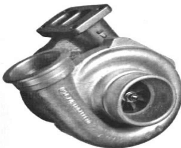
Φωτ. 2.11 Φυγοκεντρικός υπερσυμπιεστής με πτερύγια από χάλυβα θερμικής αντοχής.
