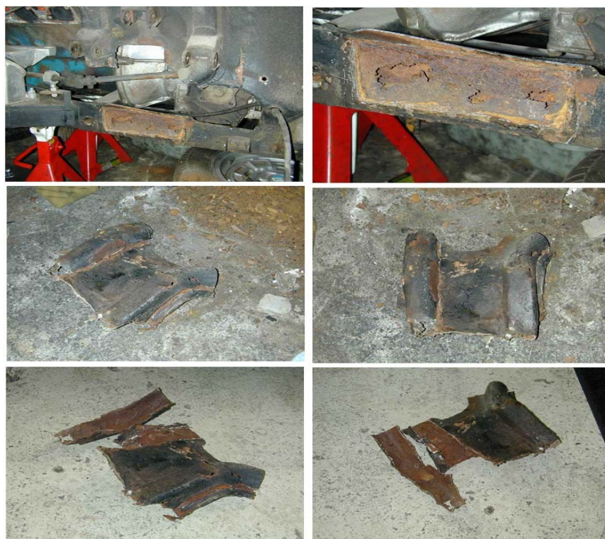
Φωτ. 1.15 Διάβρωση σε τμήματα αυτοκινήτου στο εμπρόσθιο σύστημα
