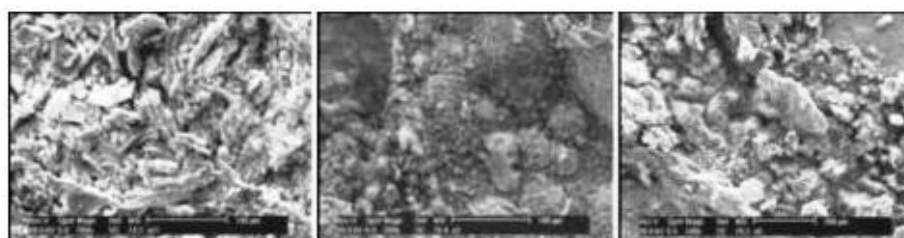
Μοντέλο 1 Μοντέλο 2 Μοντέλο 3 (β) Μετά το τεστ ASTM B 117 ψεκασμού άλατος
