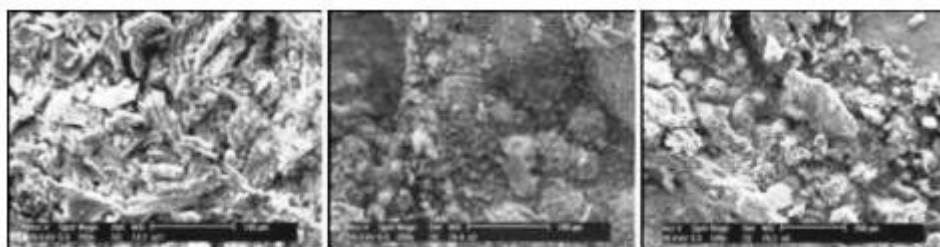
Μοντέλο 1 Μοντέλο 2 Μοντέλο 3 (α) Πριν τα τεστ επιταχυμένης διάβρωσης
