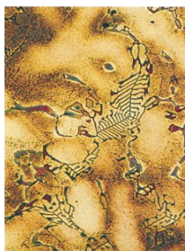
Φωτ. 2.7 Λεπτό φύλλο κράματος Al-Cu-Fe-Mn-Si.
