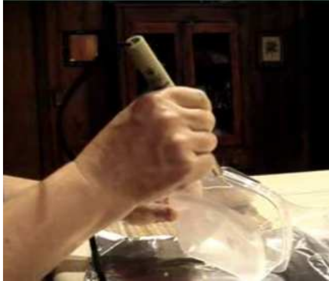
Εικόνα 45. Σε κοινά τάπερ για αποθήκευση τροφών ανοίγονται τρύπες μικρής διατομής και στις 4 πλευρές. Στη συγκεκριμένη φωτογραφία οι τρύπες ανοίγονται με ηλεκτρικά θερμαινόμενη συσκευή. (Μελισσοκομική Επιθεώρηση).
