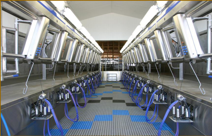
Αμελκτήριο αγελάδων τύπου ψαροκόκκαλου
