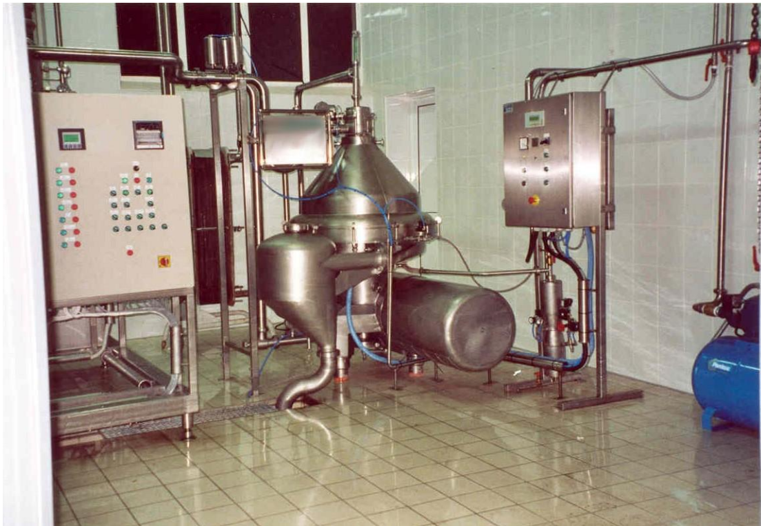
Εικόνα 13: Βακτηριοκαθαριστής Alfa-Laval MRPX 418 HGV (πηγή: www.lekkerkerker.nl )
