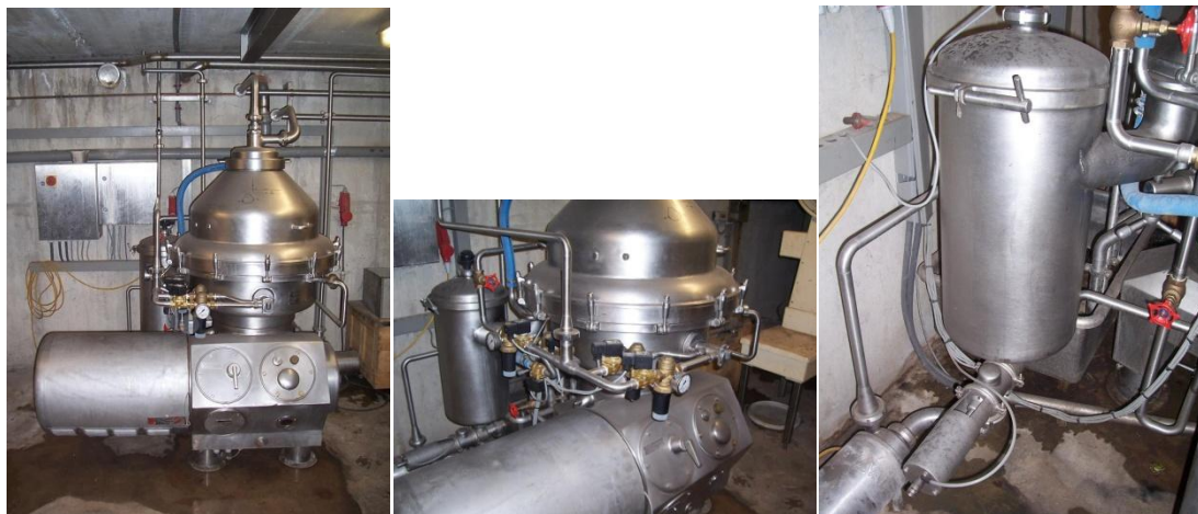
Εικόνα 10: Φωτογραφίες βακτηριοκαθαριστή από διαφορετικές γωνίες όπου διακρίνεται ο κάδος συγκέντρωσης της βακτηριομάζας (πηγή: www.dairyandfoodequipment.com )
