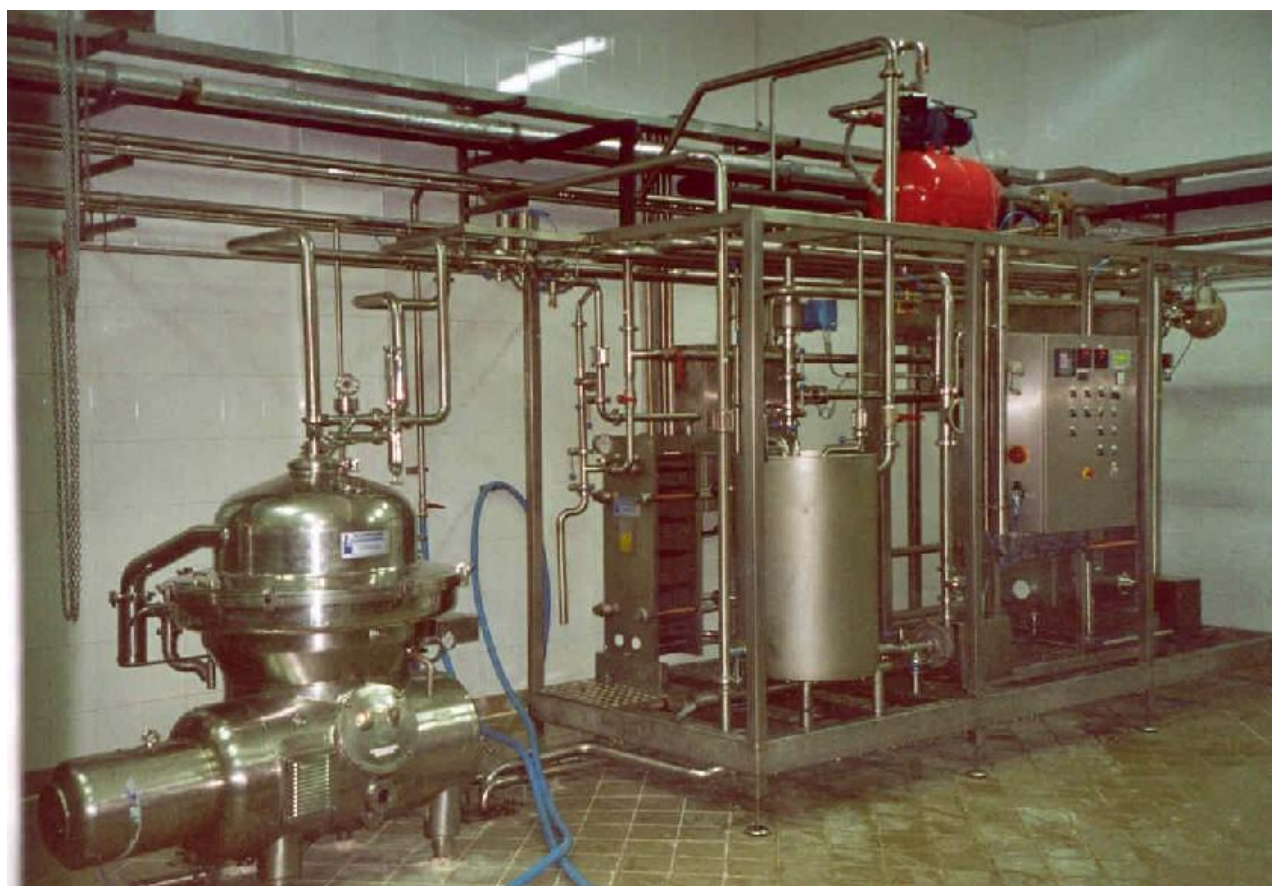
Εικόνα 18: Βακτηριοκαθαριστής σε τυροκομείο (πηγή: www.lekkerkerker.nl )
