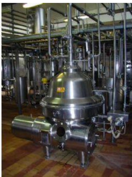
Εικόνα 1: Βακτηριοκαθαριστής (πηγή: www.processplantandmachinery.com )
