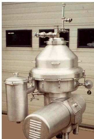
Εικόνα 16: Βακτηριοκαθαριστής Alfa-Laval 214 TGV (πηγή: www.lekkerkerker.nl )
