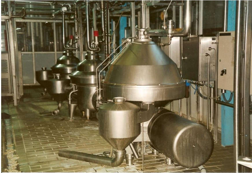
Εικόνα 25: Βακτηριοκαθαριστής που λειτουργεί στην γαλακτοβιομηχανία «ΑΓΝΟ»
