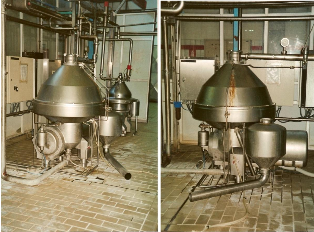
Εικόνα 24: βακτηριοκαθαριστές που χρησιμοποιούνται στην γαλακτοβιομηχανία «ΑΓΝΟ»
