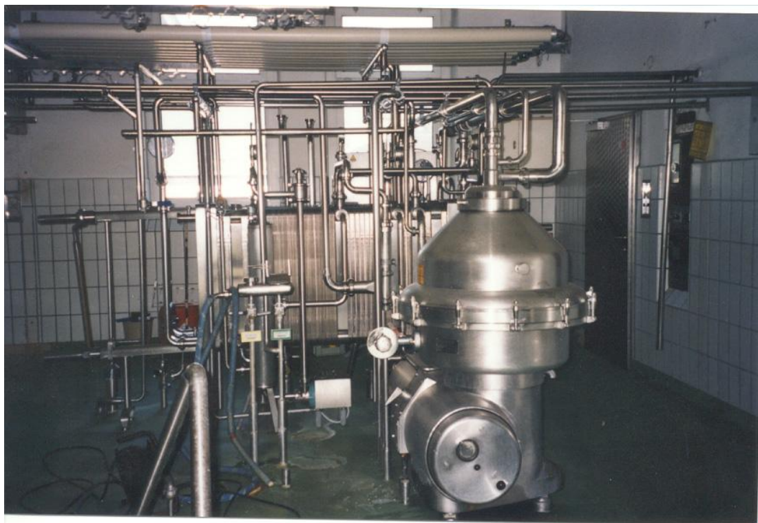
Εικόνα 9: Εγκατάσταση βακτηριοκαθαριστή (πηγή: www.matrix-cis.ru )
