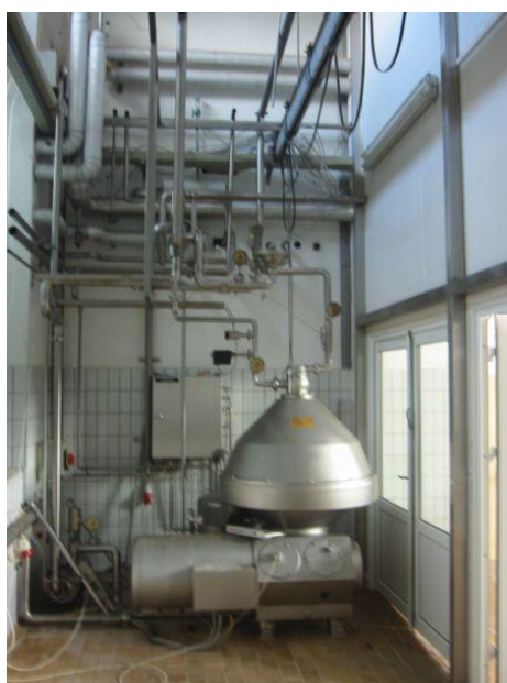
Εικόνα 3: Βακτηριοκαθαριστές BBRPX618 HGV (πηγές: www.secondhand-equipment.com και www.used-milk-centrifuges.com )
