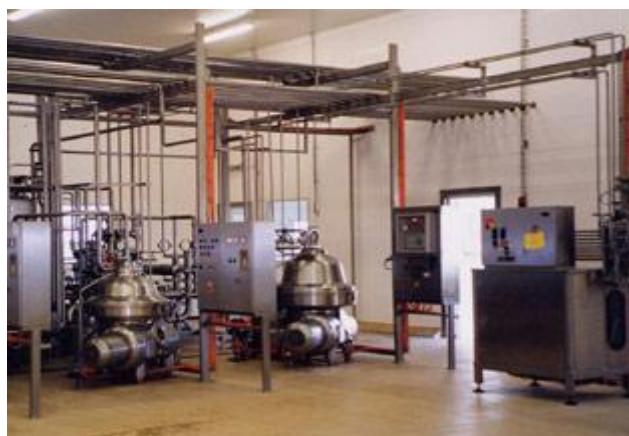
Εικόνα 17: Εγκατάσταση τυροκομίας με δύο βακτηριοκαθαριστές μονής φάσης σε σειρά (πηγή: www.tecnal.fr )
