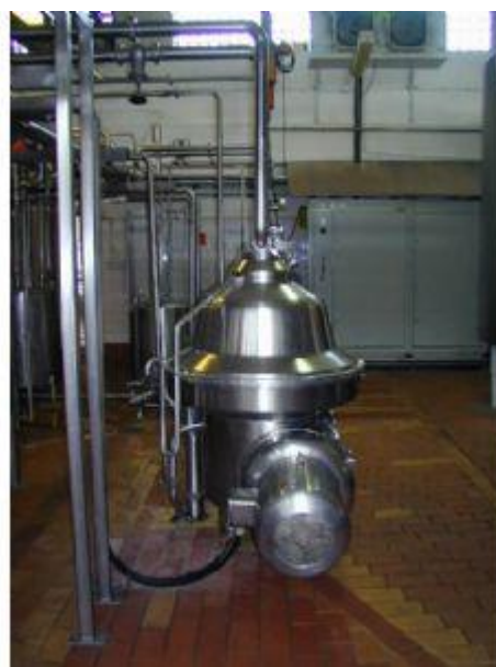
Εικόνα 1: Βακτηριοκαθαριστής (πηγή: www.processplantandmachinery.com )
