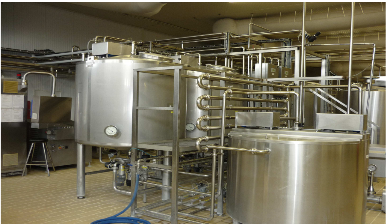
Εικόνα 23 δεξαμενές ανάμιξης παστεριωμένου γάλακτος με κακάο και γλυκαντικές ουσίες
