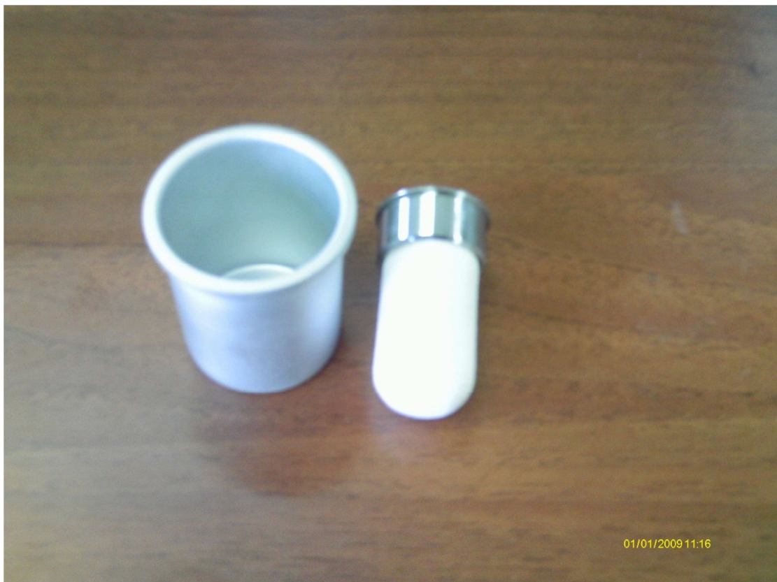
ΜΕΤΑΛΙΚΟ ΓΙΑ ΠΡΟΣΘΗΚΗ ΑΙΘΕΡΑ ΚΑΙ ΧΑΡΤΙΝΟ ΦΙΛΤΡΟ ΓΙΑ ΠΡΟΣΘΗΚΗ ΔΕΙΓΜΑΤΟΣ ΓΙΑ ΤΟ ΛΙΠΟΣ
