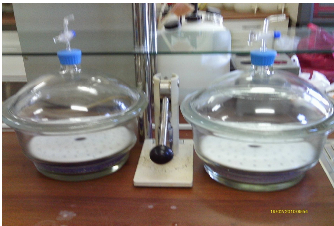
ΓΥΑΛΙΝΟΙ ΞΗΡΑΝΤΗΡΕΣ ΜΕ ΟΞΕΙΔΙΟ ΤΟΥ Si
