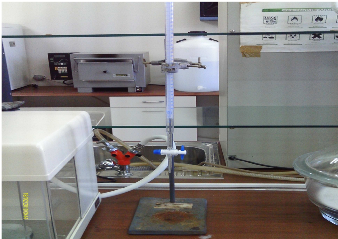
ΟΓΚΟΜΕΤΡΙΚΟΣ ΣΩΛΗΝΑΣ ΜΕ ΕΛΕΧΩΜΕΝΗ ΒΑΛΒΙΔΑ ΕΞΑΓΩΓΗΣ ΟΞΕΟΣ
