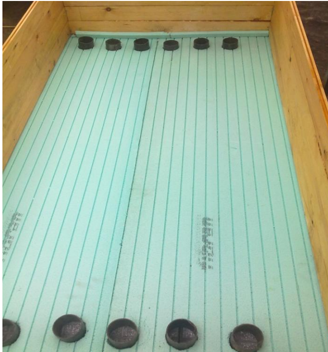
Φωτ.3.1 ,3.2 όψη της λεκάνης από πάνω, φαίνεται η βάση από μονωτικό υλικό ,και οι πλαστικοί σωλήνες καθώς και τα πλαϊνά τοιχώματα από ξύλο . Φωτ.3.3, 3.4 . όψη της λεκάνης από το πλάι, φαίνεται η βάση από πλακάκια πεζοδρομίου ,και πάνω από αυτά πλάκες από μονωτικό υλικό .
