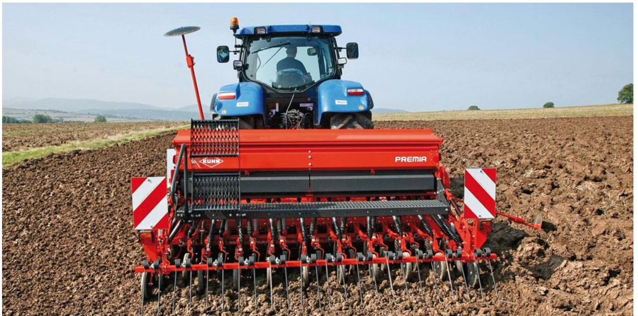
Εικόνα 5 Σπορά με σπαρτική μηχανή σιτηρών. Η σπορά του βίκου απαιτεί την χρήση τέτοιων μηχανών
