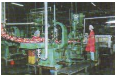
Εικ.13.18 Συγκρότημα γεμιστικού-κλειστικού κυτίων τοματοπολτού.
