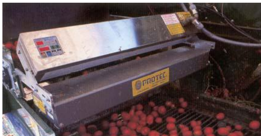
Εικ.13.7 Φωτοκότταρα χρωματικής διαλογής τομάτας
