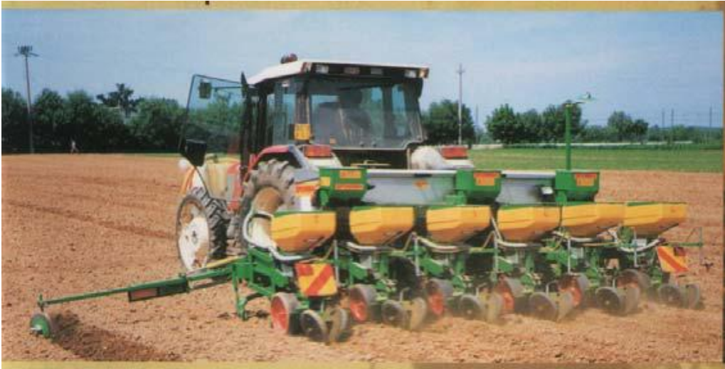
Εικόνα 8.2. Σπαρτική μηχανή πνευστού τύπου
