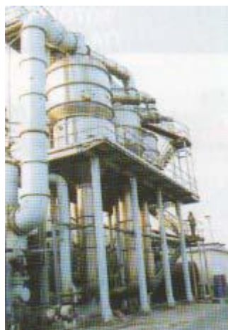
Εικ.13.16 Συγκρότημα συμπυκνωτού χυμού τομάτας συνεχούς ροής.
