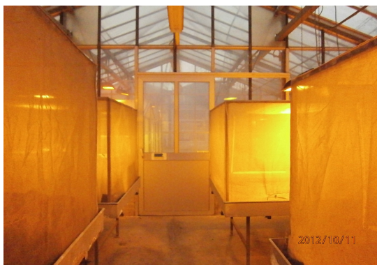
Εικόνα 11 και 12: Σταθεροί εντομολογικοί θάλαμοι μεγάλων διαστάσεων (αριστερά) και φορητός εντομολογικός θάλαμος μικρών διαστάσεων (δεξιά) . (Πηγή: Ιουλία Κυριακίδου. DIVARPA, 2013)
