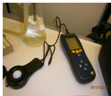
Εικόνα 15,16: Ολφακτόμετρο (αριστερά) και φωτόμετρο (δεξιά) (Πηγή: Ιουλία Κυριακίδου. DIVARPA, 2013)
