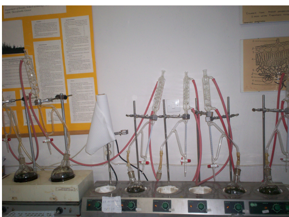
Εικόνα 8. Συστοιχία αποστακτικών συσκευών στο Εργαστήριο Αρωματικών φυτών του ΑΤΕΙΘ
