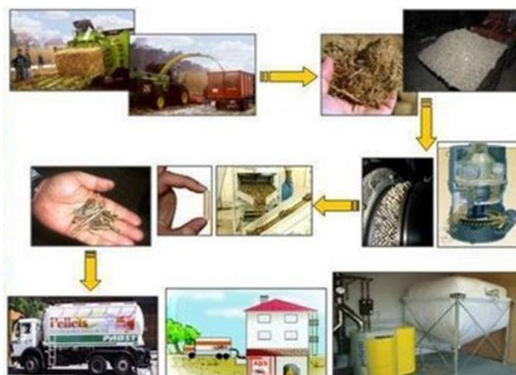
Εικόνα 30: Σχηματική διαδικασία παραγωγής πελλετών
