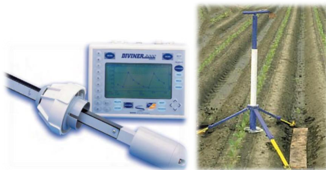
Εικόνα 14 : Diviner 2000 A) Ράβδος αισθητήρων & καταγραφικό υγρασίας B) Σύστημα διάνοιξης οπής και εγκατάστασης σωλήνων PVC
