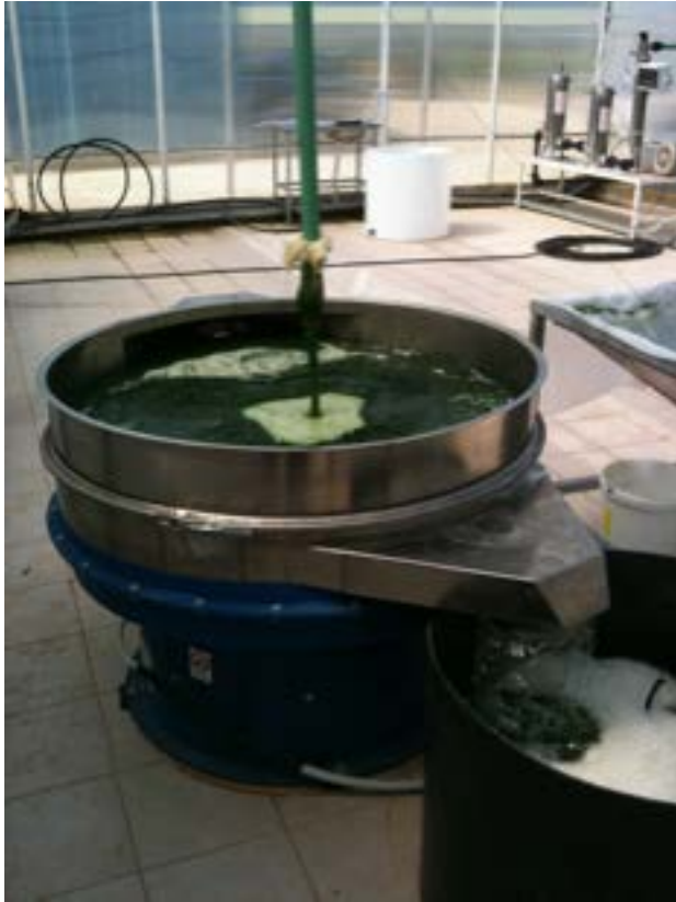
Φυγοκεντρικός διαχωριστής όπου διαχωρίζει το τρόφιμο διάλυμα της σπιρουλίνας.
