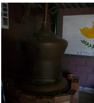
Εικόνα 43. Καζάνιζη απόσταξης. (Πηγή: Στεφανίδου Αγγελική)
