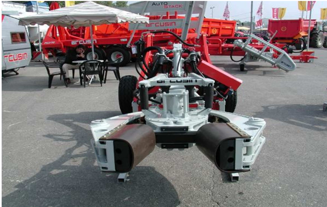
Εικόνα 22. Δομητής συγκομιδής αμυγδάλων. Ο ίδιος δομητής χρησιμοποιείται και στην συγκομιδή ελιάς (terra.gr)
