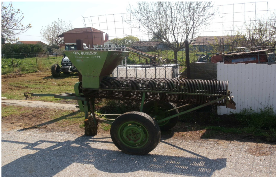
Εικόνα 23. Αποφλοιωτική μηχανή διαχωρισμού του σαρκώδους περικαρπίου (Καστανίδου Κατερίνα)
