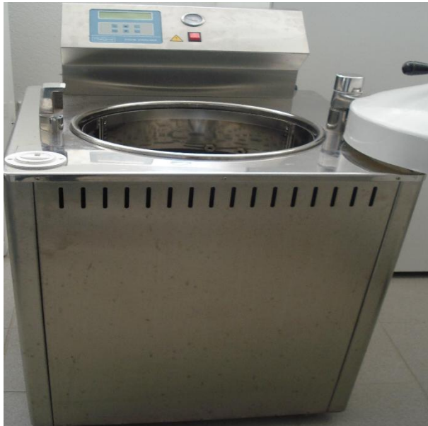
Εικόνα 5.1. Υγρός κλίβανος για την αποστείρωση του θρεπτικού υποστρώματος που είναι τοποθετημένο στα βαζάκια.
