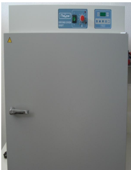
Εικόνα 5.4. Ξηρός κλίβανος που χρησιμοποιήθηκε για την αποστείρωση μικροεργαλείων, γυαλικών κ.ά. αντικειμένων που χρησιμοποιούνται στην ιστοκαλλιέργεια.
