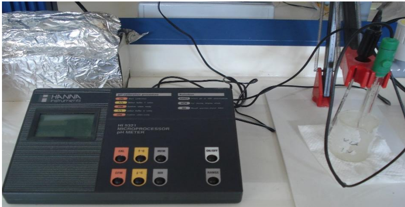
Εικόνα 5.5. pH-μετρο για τη μέτρηση της οξύτητας του θρεπτικού υποστρώματος.
