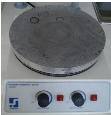
Εικόνα 5.6. Θερμική εστία και Μαγνητικός αναδευτήρας για τη παρασκευή του θρεπτικού υποστρώματος.
