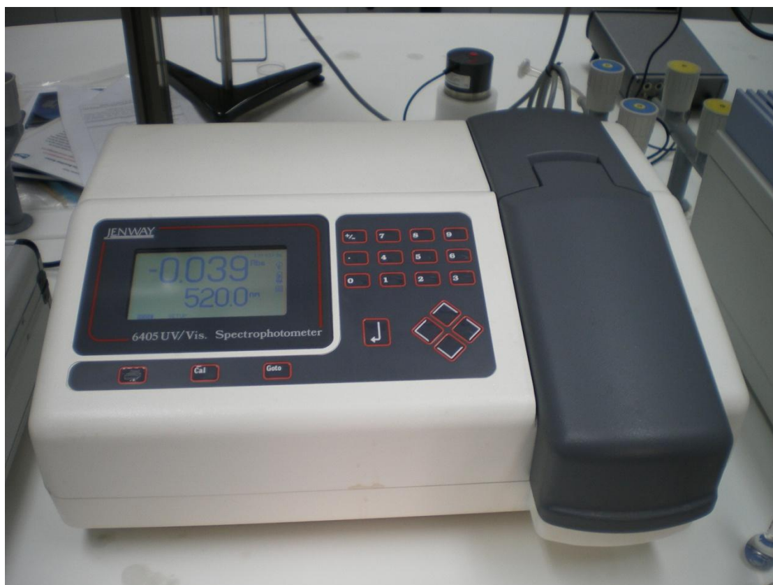
Εικ.14 UV Φασματοφωτόμετρο (UV Spectrophotometer) για μέτρηση της απορρόφησης στα 520 nm (εύρος μέτρησης 320-700 nm)
