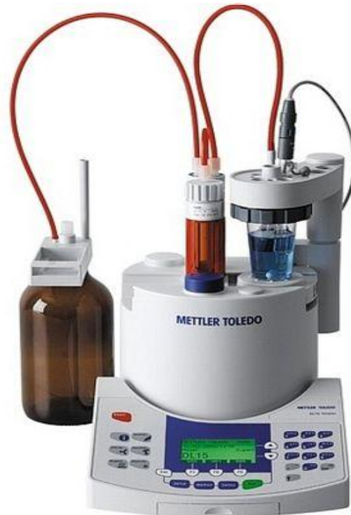
Εικ.24 Αυτόματος Τιτλοδότης (Mettler Toledo Titrator) με 0.1N NaOH για μέτρηση της οξύτητας που εκφράζεται σε g/l mallic acid
