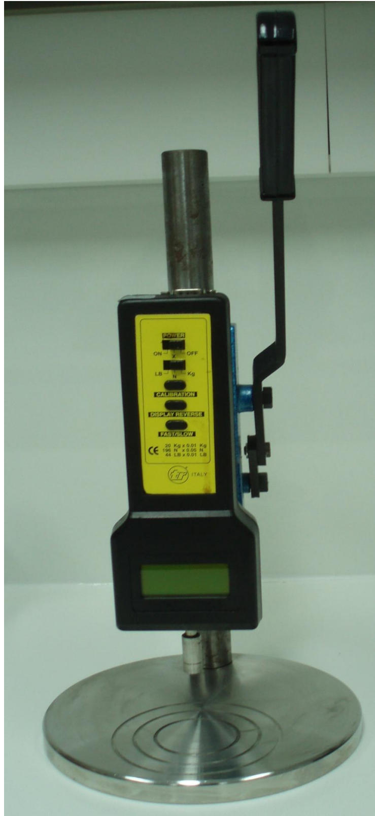
Εικ.29 Πενετρόμετρο (Penetrometer) για μέτρηση της συνεκτικότητας (kg)
