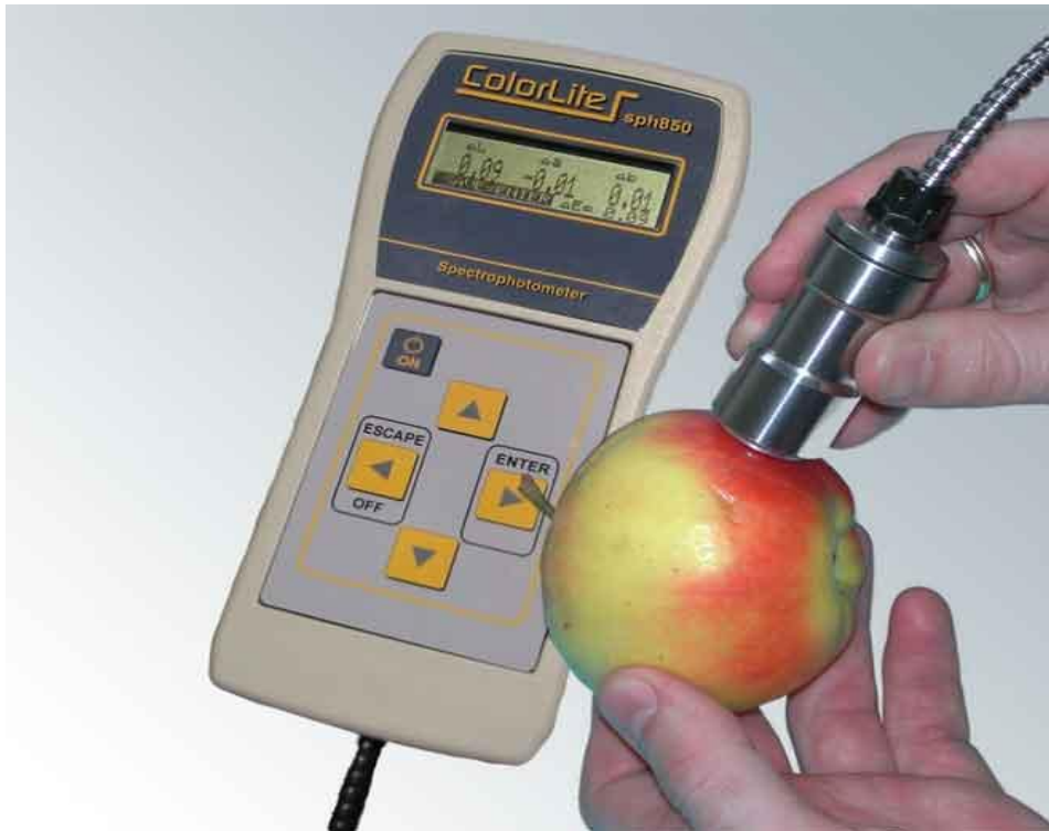
Εικ.22 Χρωμόμετρο (Colorimeter) για μέτρηση του χρώματος των καρπών (Πηγή: Υλικό από ΤΕ.ΠΑ.Κ)
