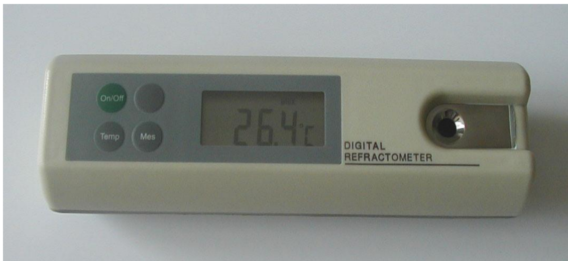
Εικ.23 Ψηφιακό Διαθλασίμετρο (Digital Refractometer): για μέτρηση σακχάρων (%) (Πηγή: Υλικό από ΤΕ.ΠΑ.Κ)
