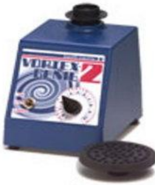
Εικ.26 Vortex για καλύτερη ομογενοποίηση (για να πάρουμε όσο περισσότερο ασκορβικό οξύ γίνεται)
