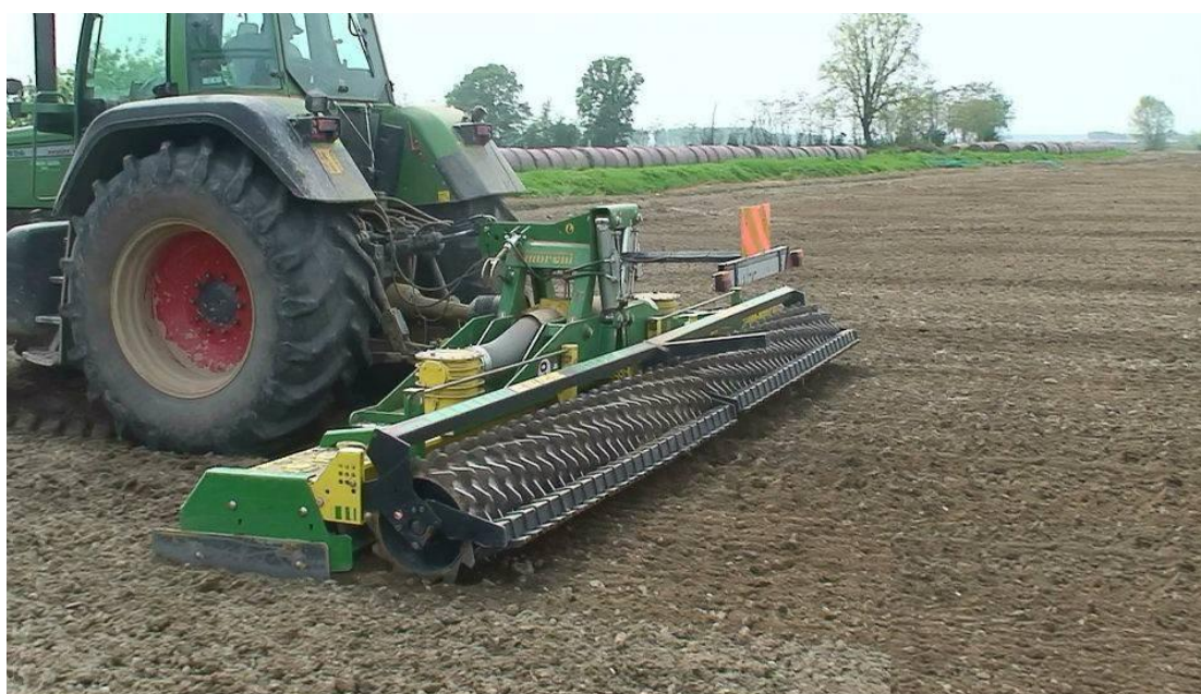
Εικόνα 7 Αγρός στον οποίο διακρίνονται οι επιφανειακές αυλακώσεις που διαμορφώθηκαν από τη φρέζα
