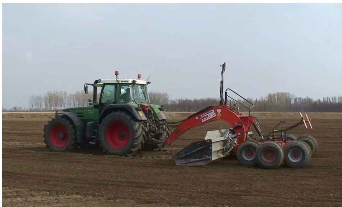
Εικόνα 6 Ισοπέδωση ορυζώνα με την εφαρμογή ακτίνων Laser
