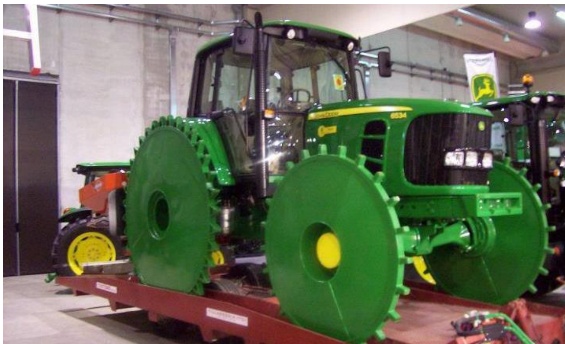
Εικόνα 8 Ελκυστήρας με οδοντωτούς τροχούς, κατάλληλος για σπορά και λίπανση ορυζώνα υπό κατάκλιση
