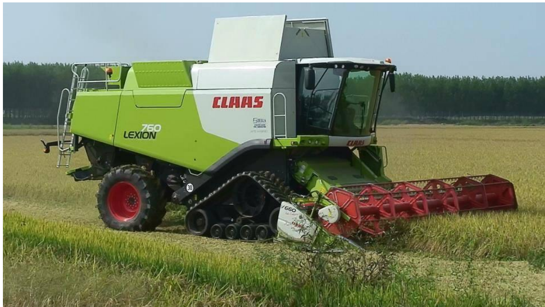
Εικόνα 12 Θεριζοαλωνιστική μηχανή ρυζιού με ερπύστριες
