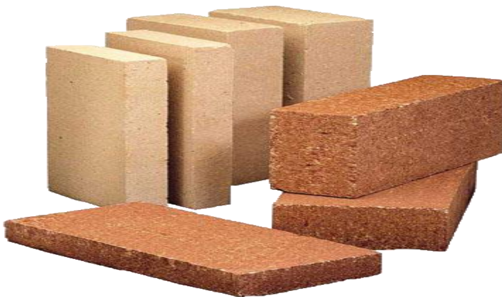
Εικόνα 27 Πυρίμαχα τούβλα, κατασκευασμένα από τέφρα φλοιών ρυζιού (πηγή: www.akek.gr )
