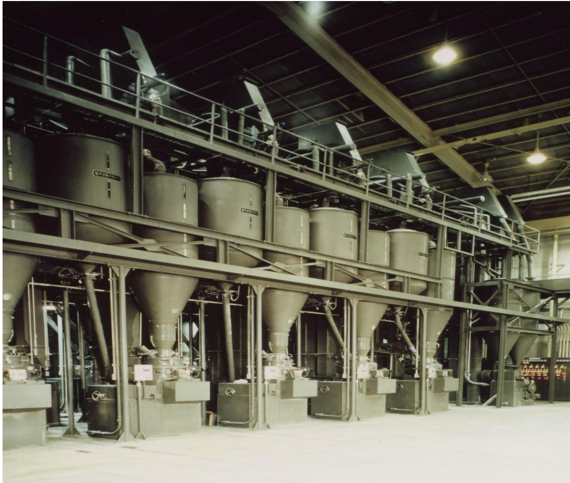
Εικόνα 25 Επιφανειακή κατεργασία ρυζιού (milling)
