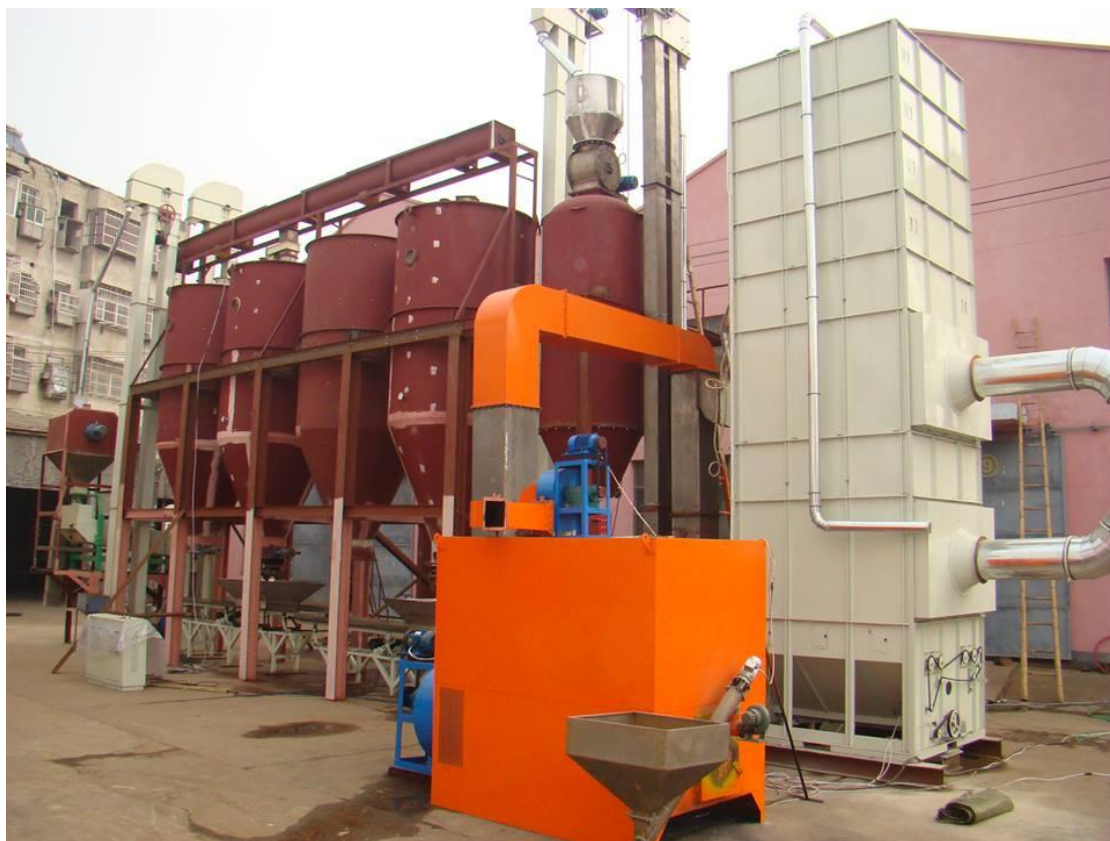
Εικόνα 24 Επιφανειακή κατεργασία ρυζιού (parboiling) (πηγη: www.en.bishan.com )
