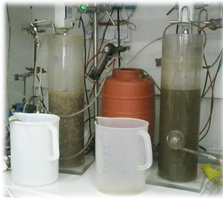
Σχήμα 15. Εργαστηριακή παράταξη των αντιδραστήρων επεξεργασίας λυμάτων.
