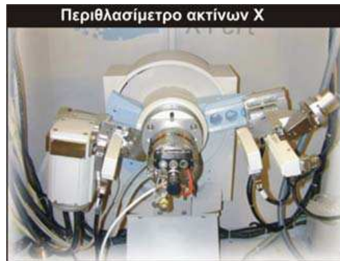
Σχήμα 14. Περιθλασίμετρο ακτίνων X (Χατζηγιάννης κ.α., 1995)
