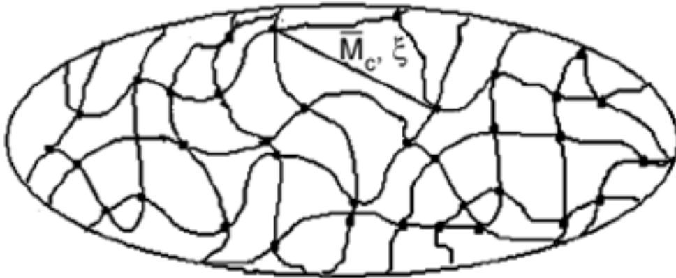
Σχήμα 1 : Σχηματική αναπαράσταση της δομής μιας ιδανικής υδροπηκτής
