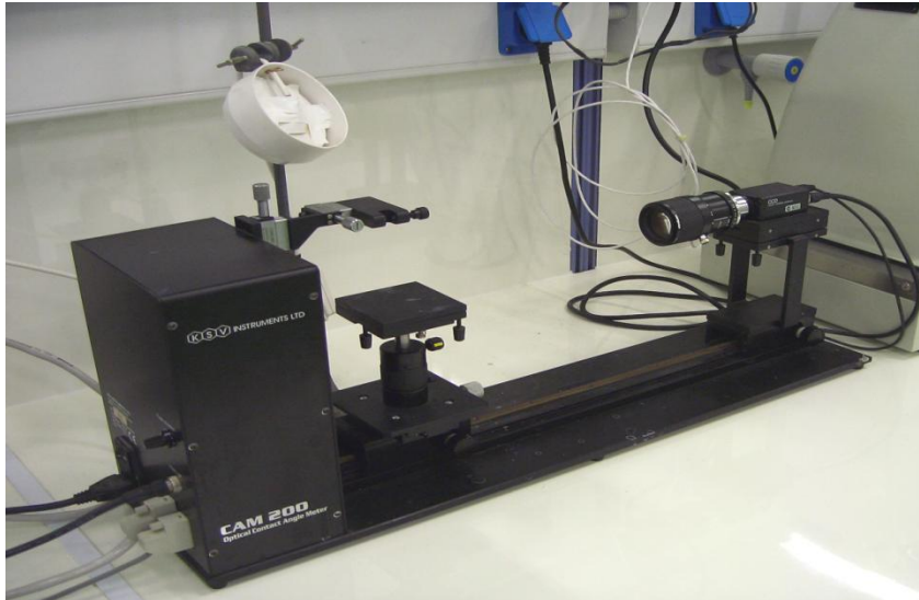
Σχήμα 11: Φωτογραφική απεικόνιση της συσκευής Cam 200 Optical Contact Angle and surface tension Meter, KSV instruments LTD.
