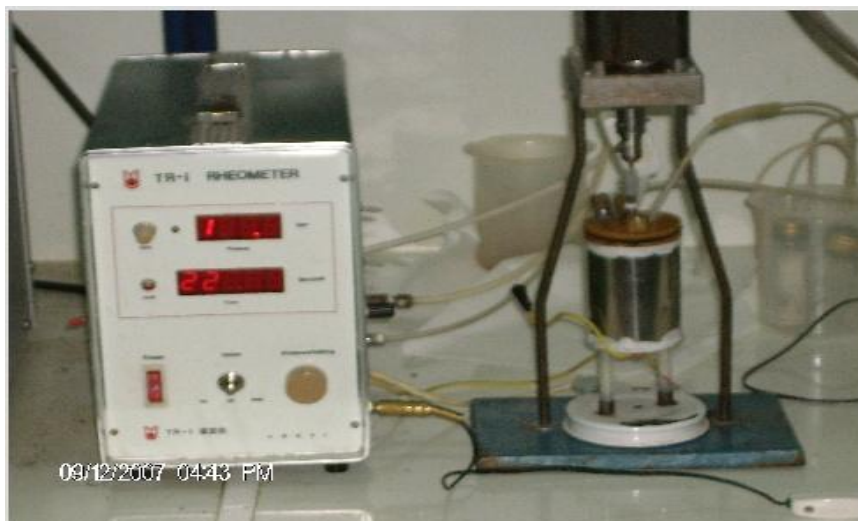
Σχήμα 8: Φωτογραφική απεικόνιση του ρεόμετρου TR-1.
