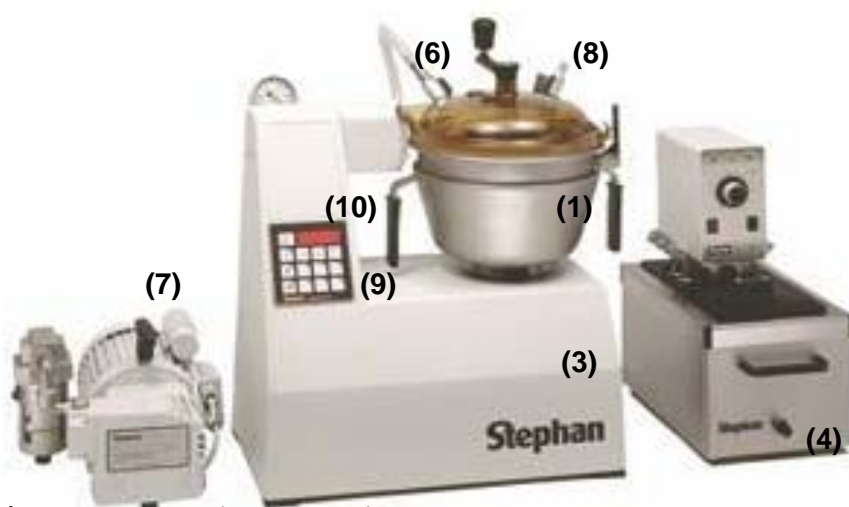
Σχήμα 14: Η συσκευή ομογενοποίησης Stephan Universal Machine UMC 5; (1) κάδος ανάμιξης, (3) κινητήρας συσκευής, (4) υδατόλουτρο, (6) χειροκίνητος αναδευτήρας, (7) αντλία κενού, (8) βαλβίδα κενού, (9) πληκτρολόγιο, (10) οθόνη όπου καταδεικνύεται ο χρόνος και η θερμοκρασία του δείγματος ανά πάσα στιγμή
